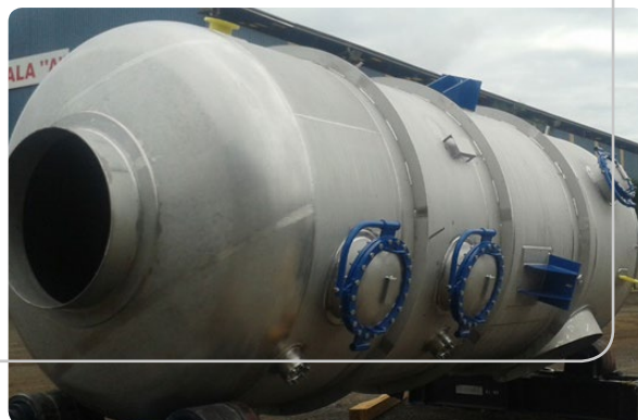
Óleo Vegetal - Condensador Barométrico
