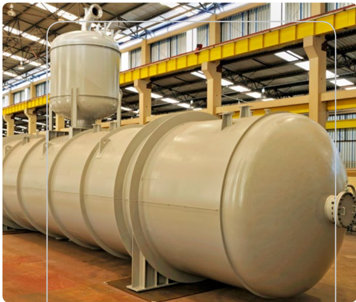
Petroquímico - Desaerador Térmico Petroquímica SUAPE - PE
