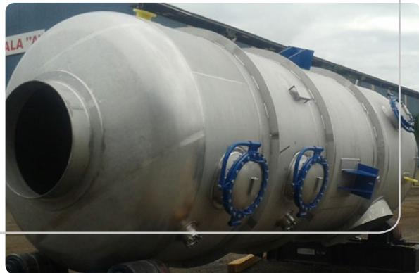
**Aceite Vegetal** - Condensador Barométrico
